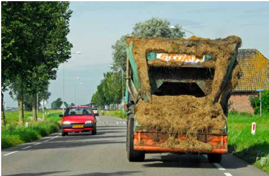
Zo moet het niet, geen verlichting zichtbaar en risico van afvallende lading.
